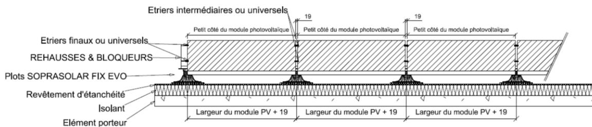
**Figure 6 : Vue de côté (sens largeur des modules) du procédé avec modules photovoltaïques en mode portrait inclinaison double ou simple shed des modules photovoltaïques – réhausse aluminium ou polymère**
