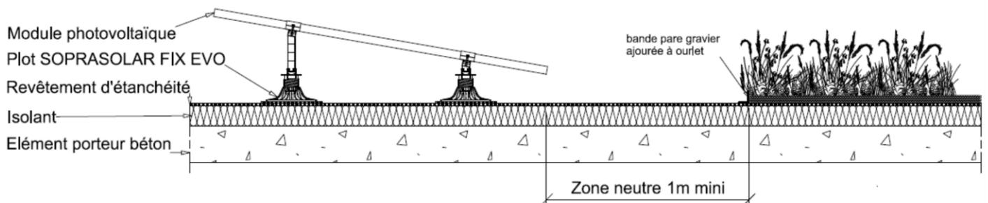
**Figure 29 : Zone neutre pour toitures terrasses à usages multiples**
