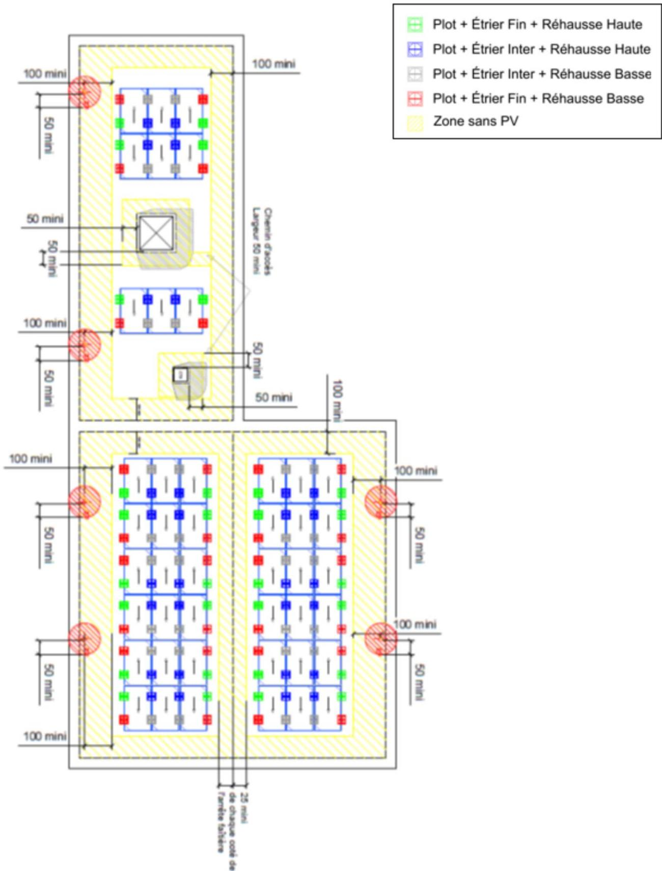
**Figure 30 : Exemple calepinage et préparation de la toiture avec modules photovoltaïques en mode portrait « double shed »**
