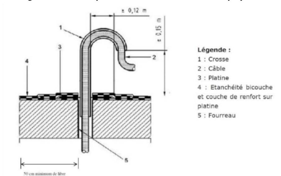
**Figure 17 : Schéma détail passage de câble à travers l'étanchéité**
