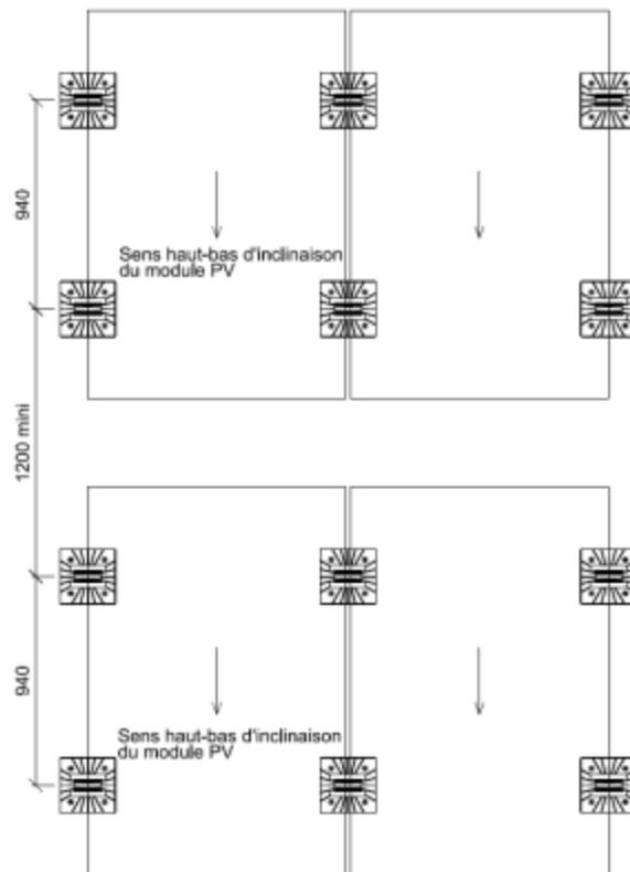
**Figure 23 : Implantation des plots SOPRASOLAR FIX EVO avec modules photovoltaïques en inclinaison simple shed - réhausse polymère**
