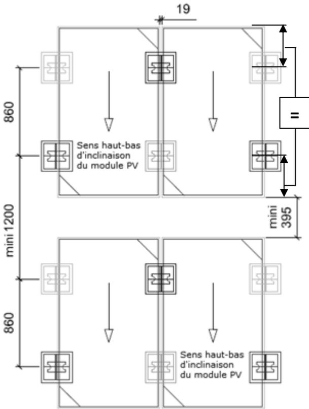
**Figure 25 : Implantation des plots SOPRASOLAR FIX EVO avec modules photovoltaïques en inclinaison double shed**
