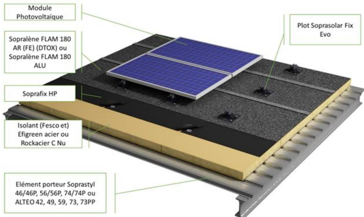
**Figure 2 : Procédé en version SOPRASOLAR FIX EVO TILT - TAN DTU sur élément porteur TAN avec revêtement d'étanchéité bicouche fixé mécaniquement et modules photovoltaïques**
