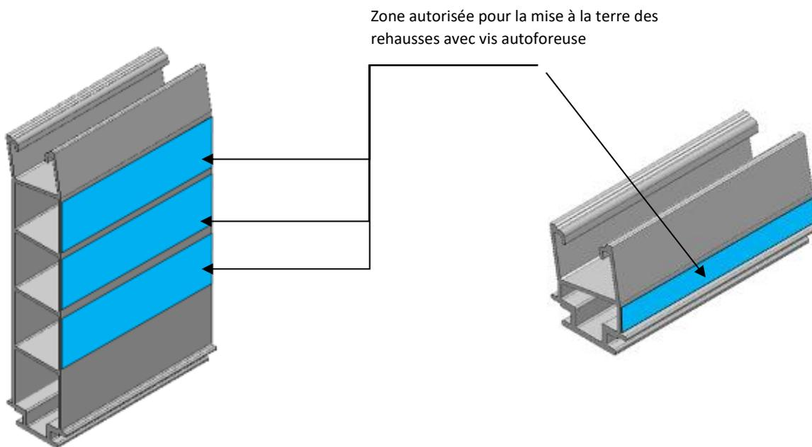
Localisation zone de perçage pour mise à la terre des rehausses par vis autopercuseuse
