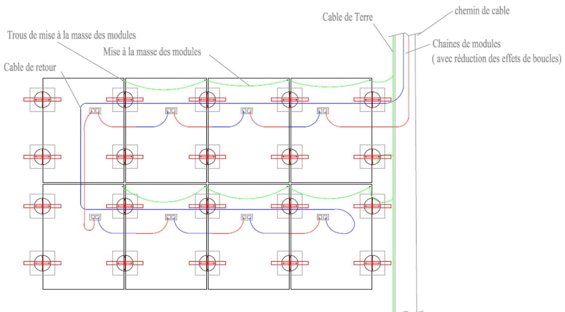
Figure 20 : Système de mise à la terre
