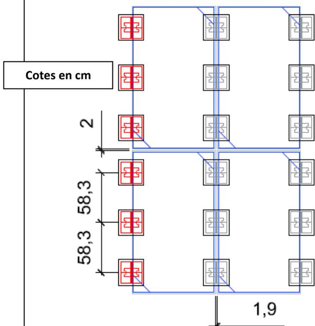
**Figure 28 : Traçage et soudage des plots SOPRASOLAR FIX EVO sur membrane d'étanchéité avec finition SOPRALENE FLAM 180 AR(Fe)**
