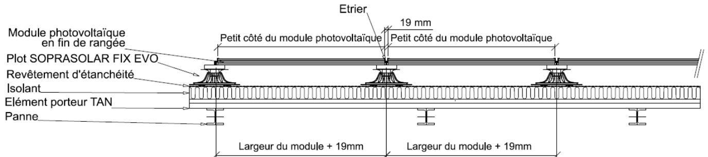
**Figure 6 : Vue en coupe (dans le sens de la longueur des modules) du procédé avec modules photovoltaïques de longueur 1 755 mm en inclinaison double shed**
