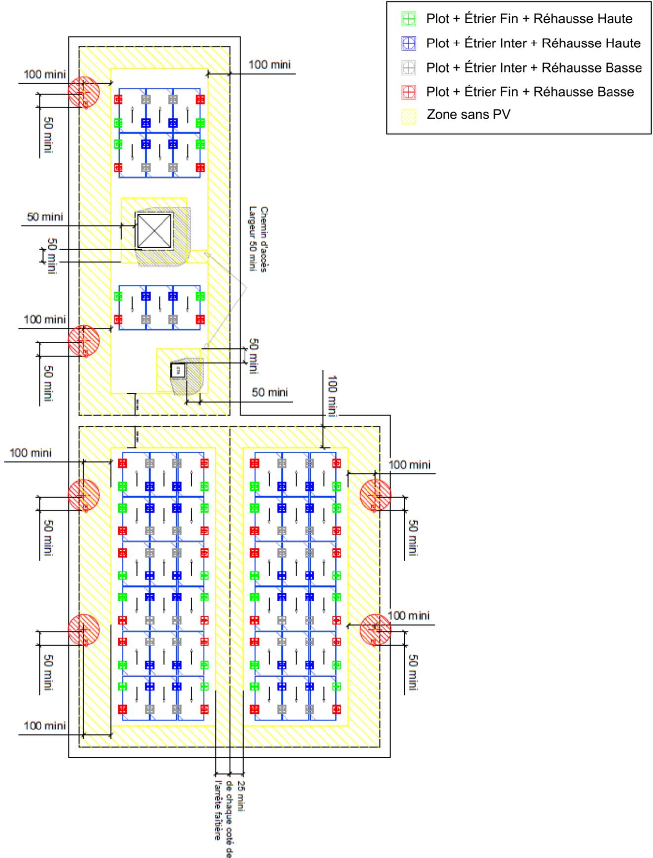
**Figure 37 : Exemple calepinage et préparation de la toiture avec modules photovoltaïques inclinés en orientation simple shed**
