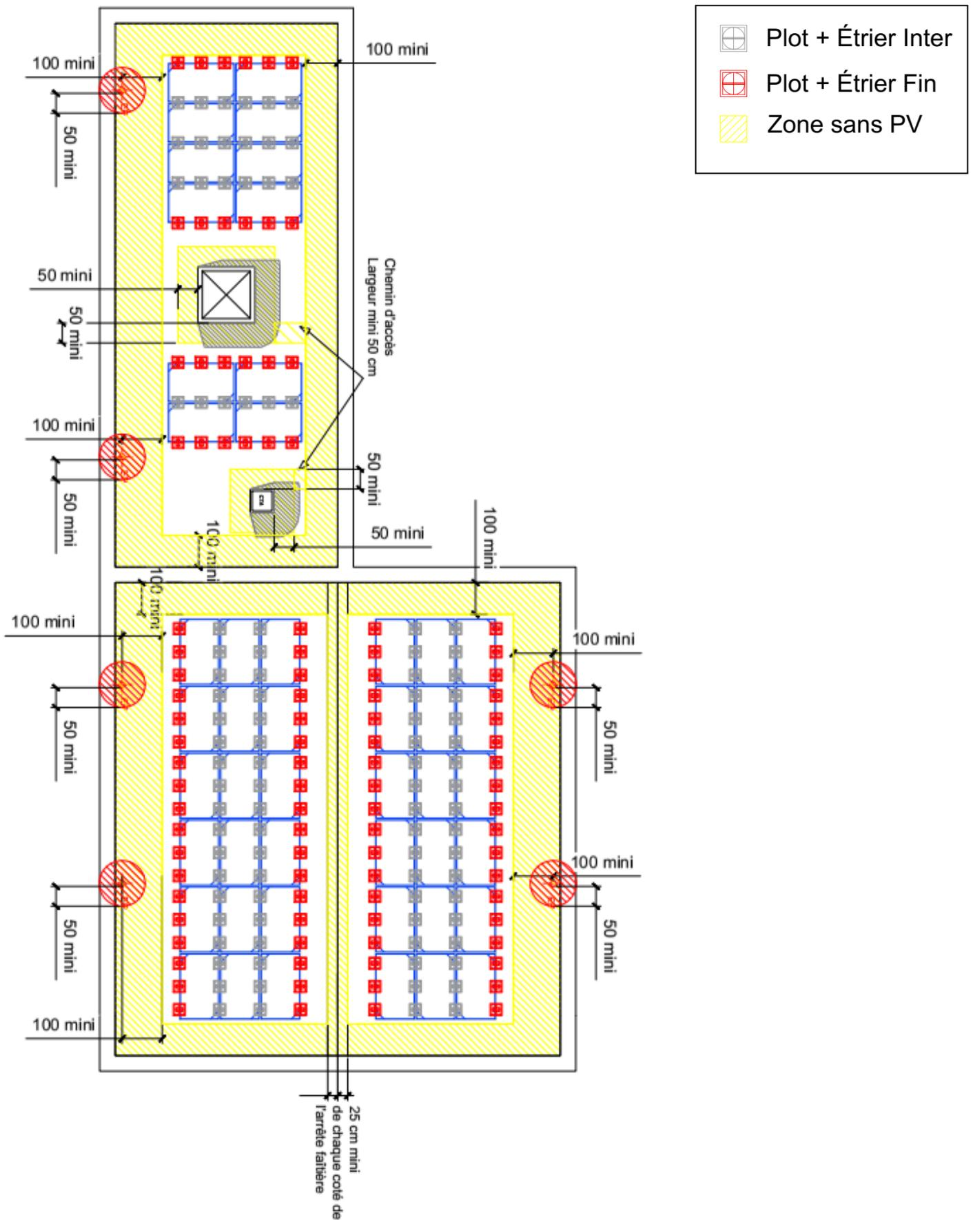
**Figure 36 : Exemple calepinage et préparation de la toiture avec modules photovoltaïques inclinés en orientation double shed**
