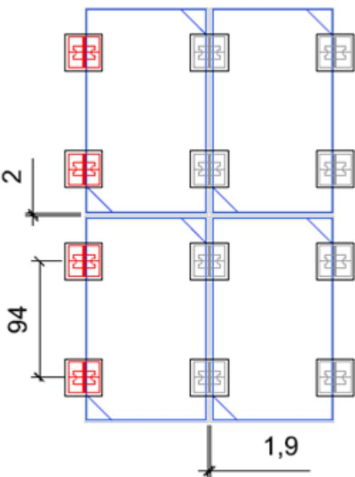
**Figure 27 : Implantation des plots SOPRASOLAR FIX EVO en calepinage densifié**
