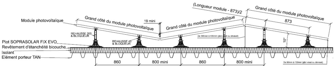
**Figure 7 : Vue en coupe (dans le sens de la longueur des modules) du procédé avec modules photovoltaïques de longueur 1 755 mm en inclinaison simple shed**
