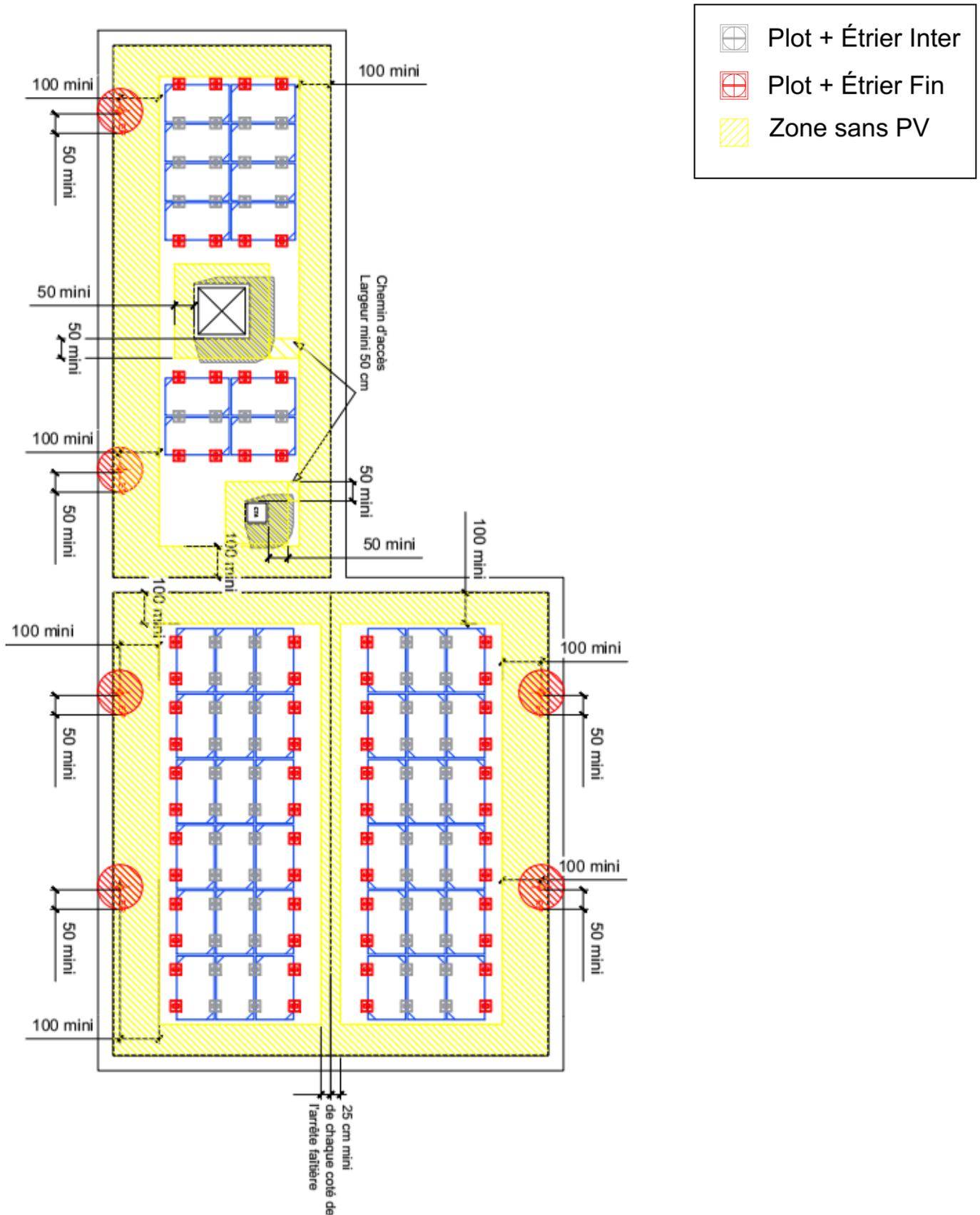
**Figure 35 : Exemple calepinage standard (3 plots/grand côté du module) et préparation de la toiture en pose à plat**
