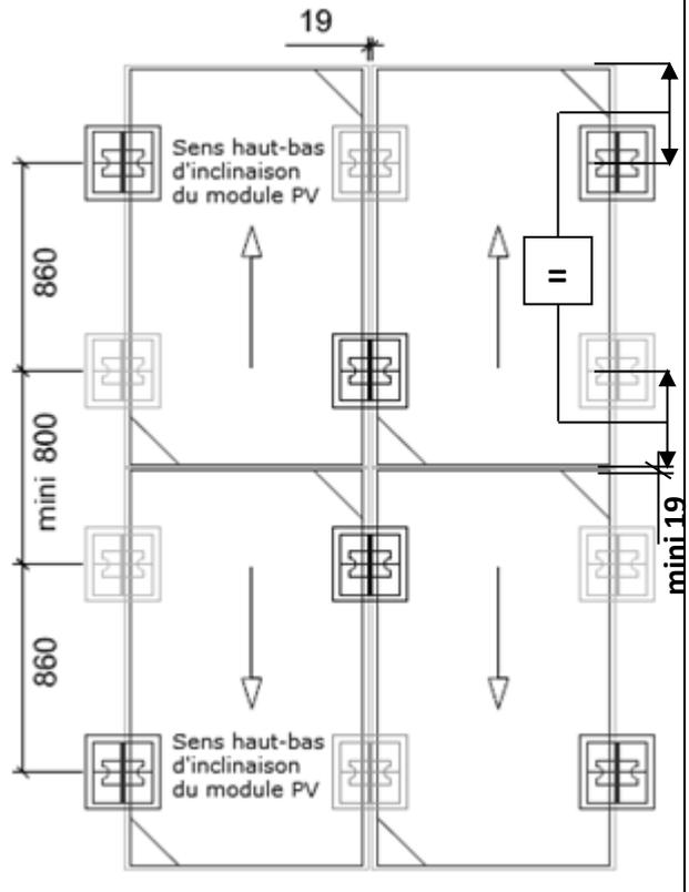
**Figure 26 : Implantation des plots SOPRASOLAR FIX EVO en calepinage non densifié**
