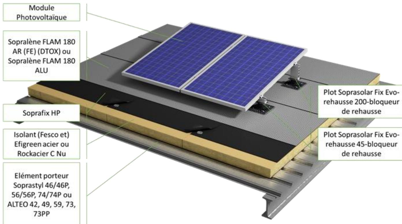
**Figure 3 : Vue en coupe (dans le sens de la longueur des modules) du procédé avec modules photovoltaïques parallèles au plan de toiture (2 plots par grand côté du module)**
