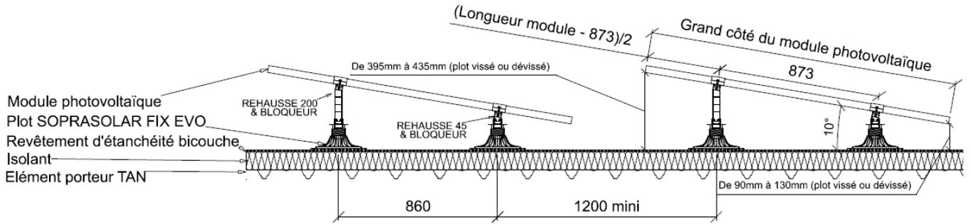
**Figure 8 : Vue de face du procédé avec modules photovoltaïques en inclinaison simple shed**
