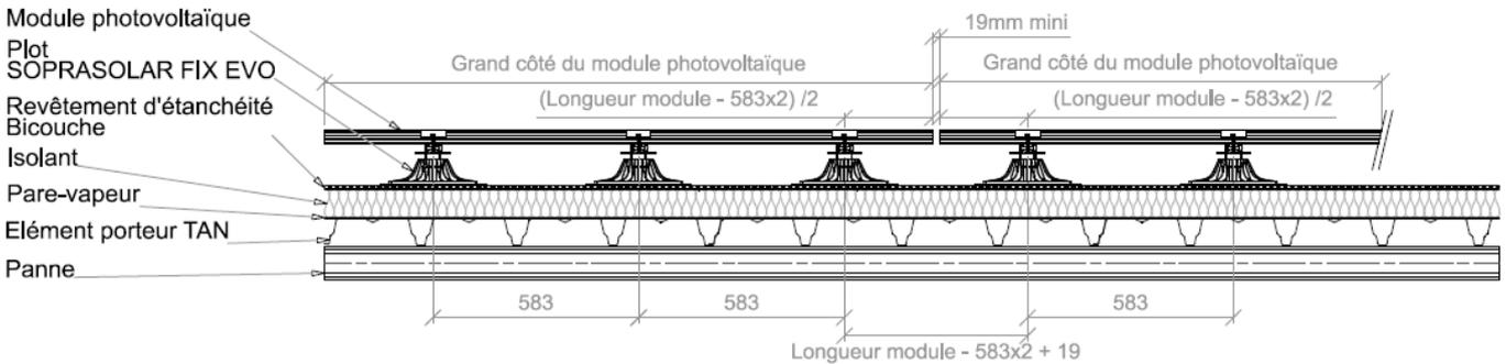
**Figure 5 : Vue en coupe (dans le sens de la largeur des modules) du procédé avec modules photovoltaïques parallèles au plan de toiture (2 ou 3 plots par grand côté du module)**
