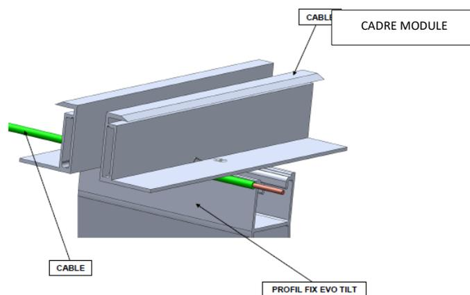
Système de mise à la terre Terragrif des modules et rehausses
