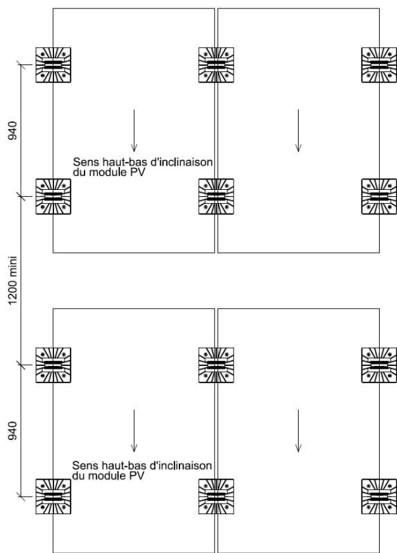
Figure 30 : Implantation des plots SOPRASOLAR FIX EVO PVC/TPO avec modules photovoltaïques en inclinaison simple shed - réhausse polymère
