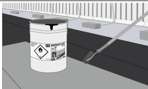
5. Appliquer le primaire SOPRASOLAR PRIM (400 g/m<sup>2</sup>) au rouleau sur une emprise de +5 cm dans chaque direction par rapport à la surface des modules. Un temps de séchage de minimum 1h doit être respecté.
