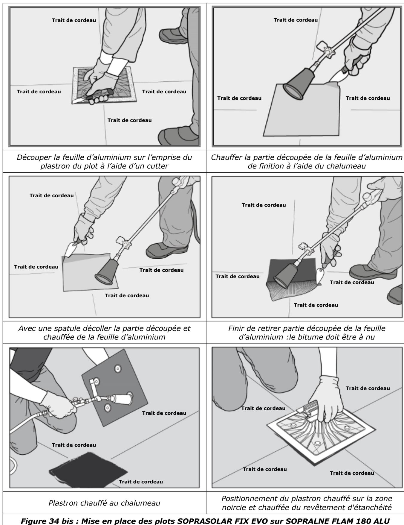
Une fois les emplacements des plots repérés et la feuille d'aluminium découpée à l'aide d'un cutter, il convient de retirer la partie de feuille d'aluminium découpée en la chauffant à l'aide d'un chalumeau et en la décollant totalement à partir d'un des coins à l'aide d'une spatule.
