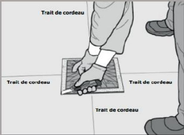
*Découper la feuille d'aluminium sur l'emprise du plastron du plot à l'aide d'un cutter*
