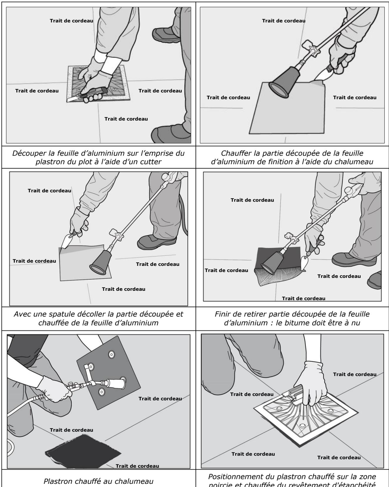
*Figure 23 : Soudage des plots du procédé SOPRASOLAR FIX EVO TILT CPP sur membrane d'étanchéité avec finition aluminium*
