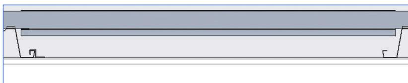
Figure 17 : ajustement latéral de la gouttière inter-module
