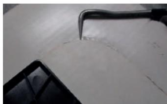
3- Vérification de la qualité des soudures à l'aide du testeur après refroidissement.
