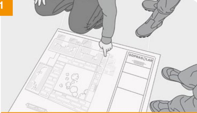
→ Vérifier les cotes de la toiture et l'emplacement des émergences par rapport au plan d'exécution avant tout traçage.
