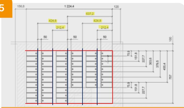
→ Repérer le positionnement des rangées de modules sur les axes «x» à l'aide des cotes cumulées du plan d'exécution. Relier les repères en traçant à l'aide du cordex. Contrôler l'équerrage tous les 8 à 10 mètres.
