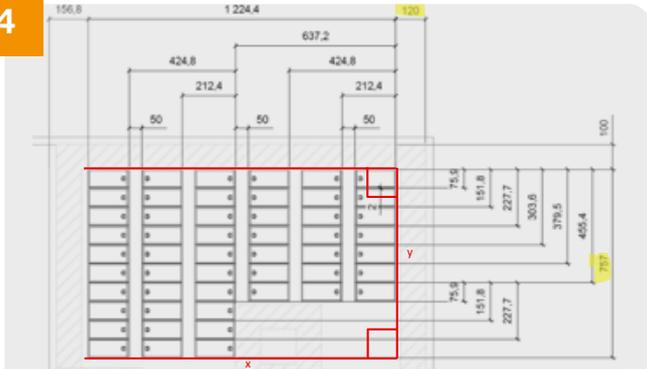
→ Tracer au cordex un axe nommé «y» perpendiculaire à «x» (voir méthode d'équerrage) positionné à l'aide de la cote de départ du plan d'exécution. Puis, tracer au cordex un second axe «x» perpendiculaire à «y» (voir méthode d'équerrage) à l'aide des dimensions du champ solaire données sur le plan d'exécution.
