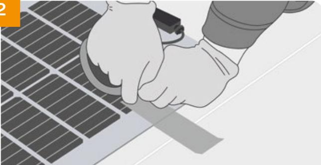
→ Verrouiller temporairement la position du module photovoltaïque avec 3 morceaux de scotch sur le long côté.
