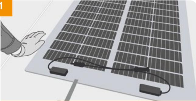
→ Positionner le module en veillant à respecter le sens des câbles électriques par rapport au plan d'exécution. Des cales peuvent être utilisées pour s'assurer du bon entraxe entre deux modules photovoltaïques.
