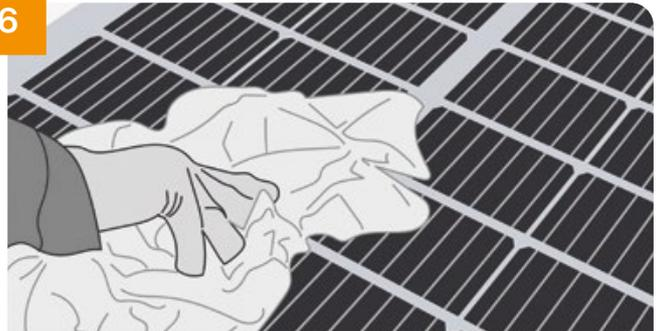
→ Maroufler au niveau des bandes de butyle à l'aide d'un chiffon propre.
