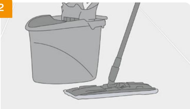
→ Nettoyer la zone destinée à recevoir l'installation solaire avec du produit de nettoyage à pH neutre. Bien rincer à l'eau claire et laisser sécher. Vérifier le séchage au papier absorbant.
