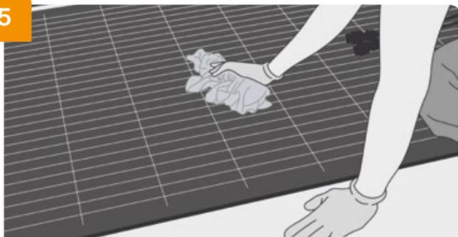
→ Maroufler au niveau des bandes de butyle à l'aide d'un chiffon propre.
