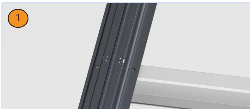
Les rails Soprasolar Park sont fixés à chaque panne par au moins deux vis autoforçantes. Les vis autoforçantes possèdent une rondelle étanche et sont positionnées dans chacune des gorges du rail.
