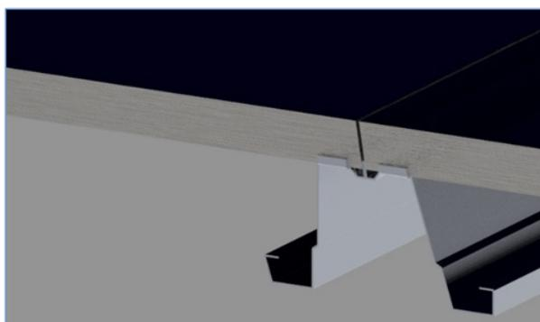
b- Insérer des clips de fixation dans chacun des poinçons du rail, tel qu'indiqué dans le plan de calepinage, de manière que chaque clip de fixation serre le retour du cadre du module et le rail tout en griffant le cadre du module (minimum 6 clips/module) ;
