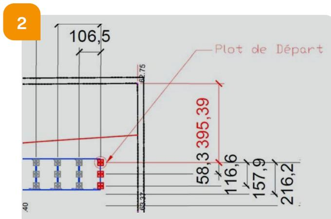
→ Vérifier l'implantation du plot de départ à l'aide du PLAN D'EXÉCUTION.
