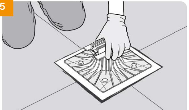
→ Appliquer le plot sur le revêtement et exercer une pression pour confirmer la soudure.
