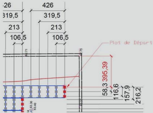
→ Tracer les repères au cordeau en respectant les cotes du PLAN D'EXÉCUTION. Vérifier l'équerrage de l'installation tout les 5 mètres (méthode 3-4-5).
