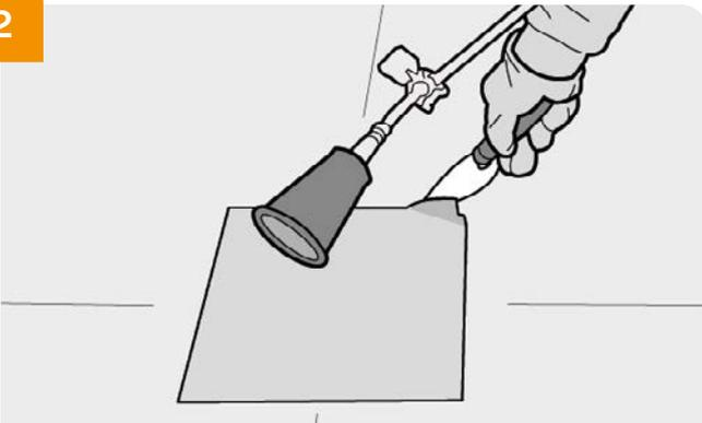
→ Chauffer la partie découpée de la feuille d'aluminium de finition à l'aide du chalumeau.
