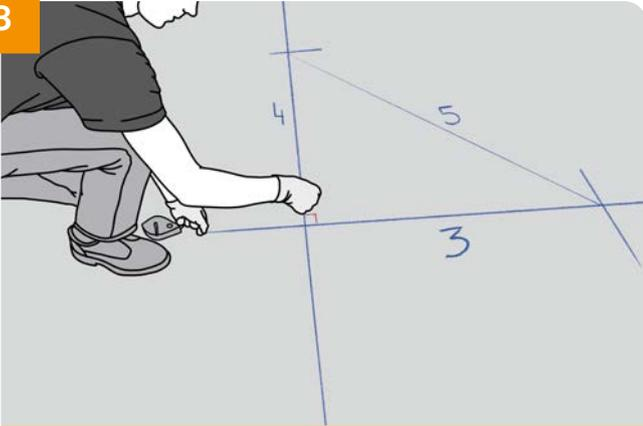
→ Réaliser l'équerrage de la zone d'implantation au cordeau avec la méthode 3-4-5.
