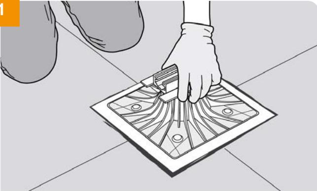
→ Découper la feuille d'aluminium sur une emprise légèrement inférieure au plastron du plot (-1 cm) à l'aide d'un cutter.
