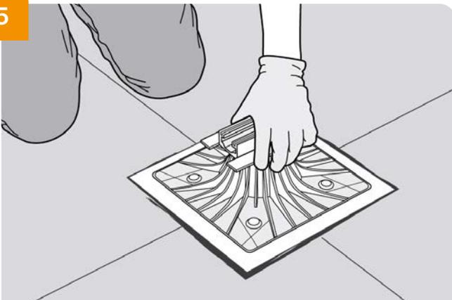
→ Positionner les plots SOPRASOLAR® FIX EVO. Le centre de chaque plot est matérialisé par l'intersection des lignes tracées.
