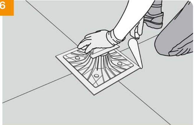
→ Tracer l'empreinte du plot à l'aide d'une spatule pour repérer sa position sur la toiture.
