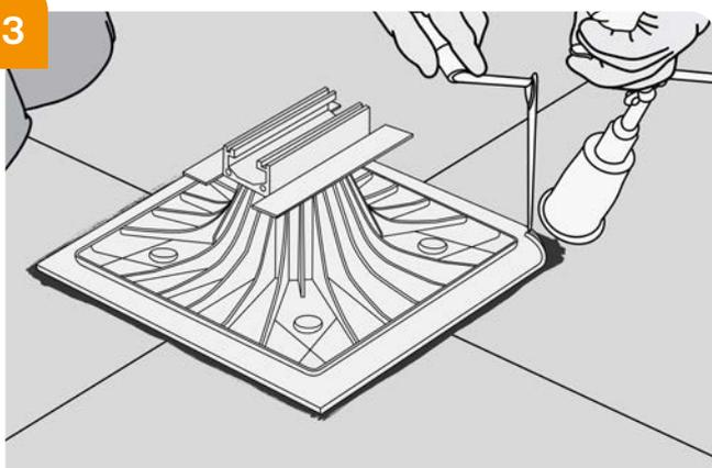
→ Si nécessaire, confirmer la soudure des coins du plastron.
