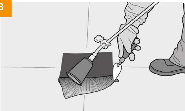
→ Retirer la partie découpée de la feuille d'aluminium ; le bitume doit être à nu.
